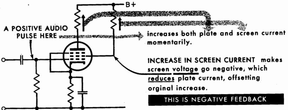
**WHEN A CAPACITOR IS CONNECTED BETWEEN SCREEN AND GROUND,**
